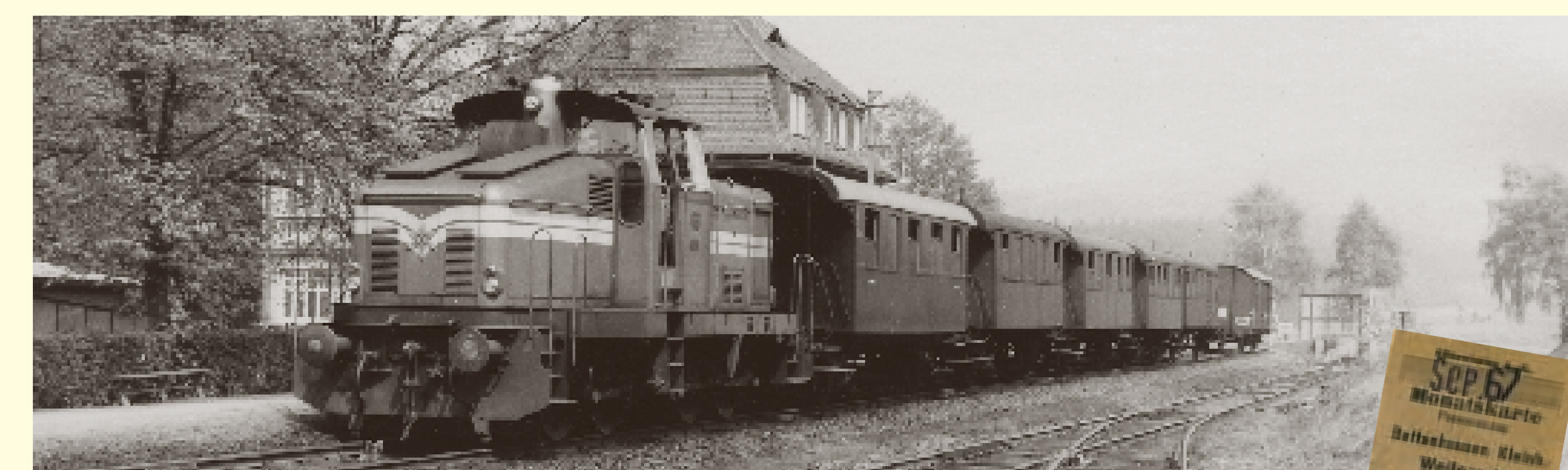
Die „Lok V 4“ der Söhrebahn – hier am Bahnhof Wellerode-Wald – war eine Diesellokomotive der Firma Henschel-Werke GmbH (Baujahr 1958).
