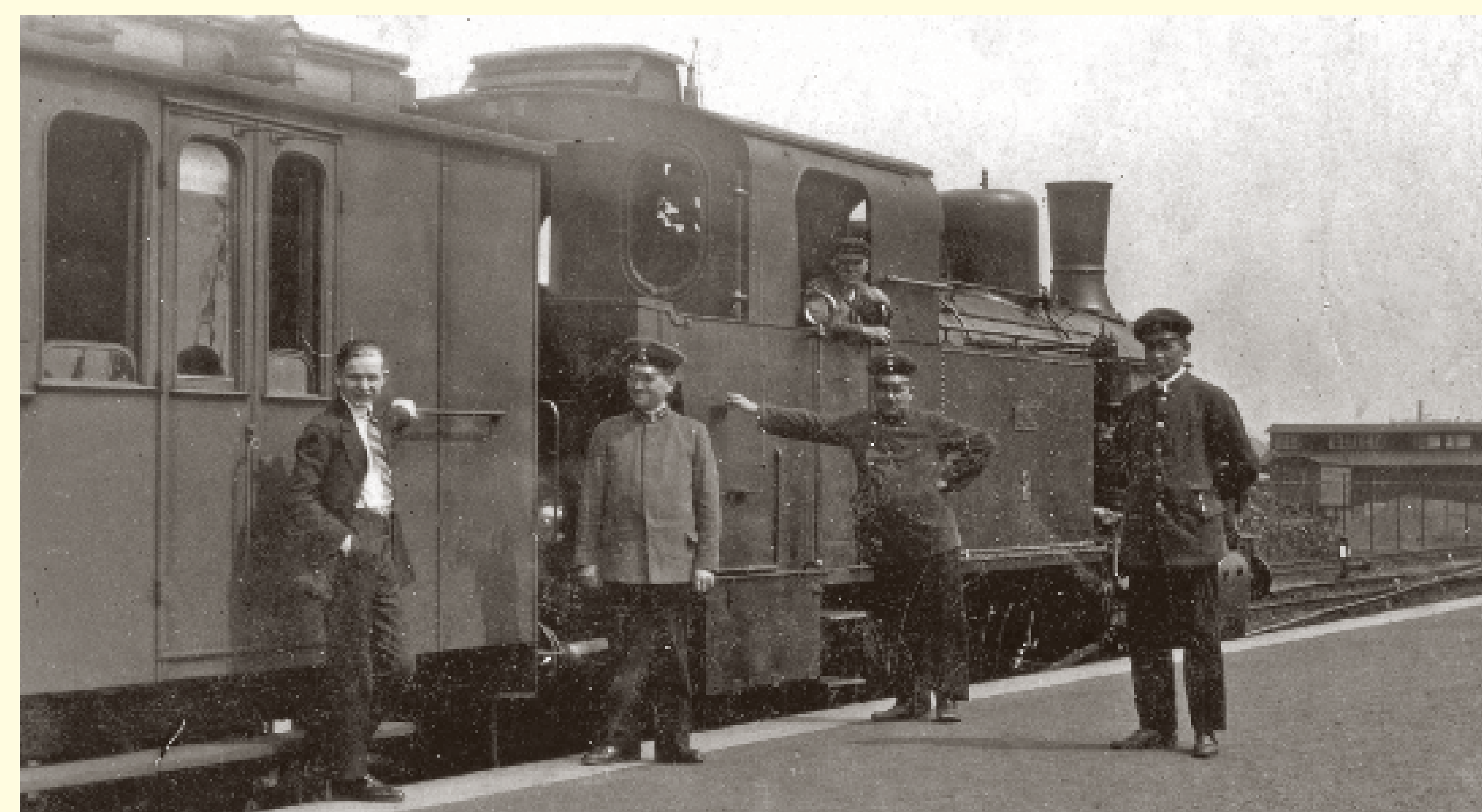
Die „Lok 2“ wurde 1912 von der Firma Henschel & Sohn gekauft (Baureihe 92, Baunummer 11102). Es handelte sich um eine vierachsige Tenderlokomotive mit 2 Zylindern und Nassdampf (Dn2t). Sie wurde später in eine Heißdampflok umgebaut.
